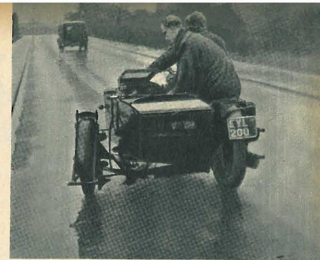
• La ruota che sbanda, misura lo sdruciolamento su strada bagnata; tutti i movimenti di essa vengono registrati graficamente. (Da "The Motor"),
